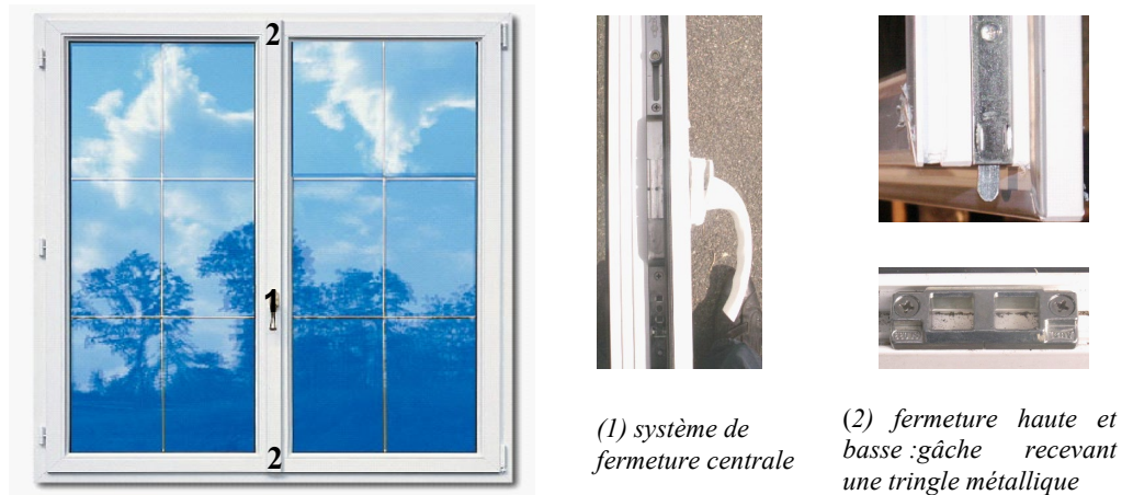
Figure 3 : illustration d'un système de fermeture à crémone avec sortie de tringle
