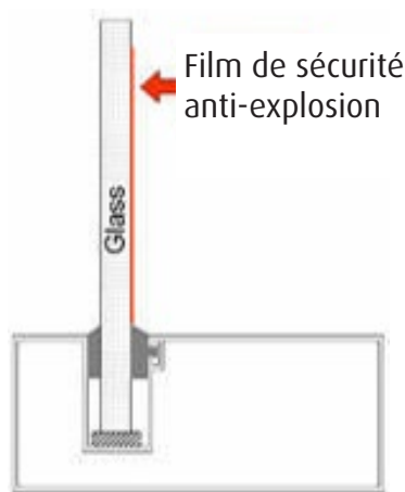
Figure 10 : fixation du film par simple adhérence
