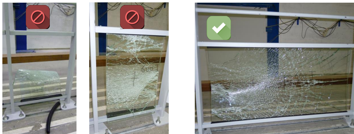
FIGURE 4 : ACCEPTABILITE DES VITRAGES SUITE A L'ESSAI
