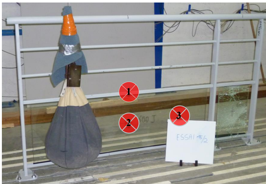
FIGURE 2 : LOCALISATION DES POINTS D'IMPACT SUR UN GARDE-CORPS MIXTE
