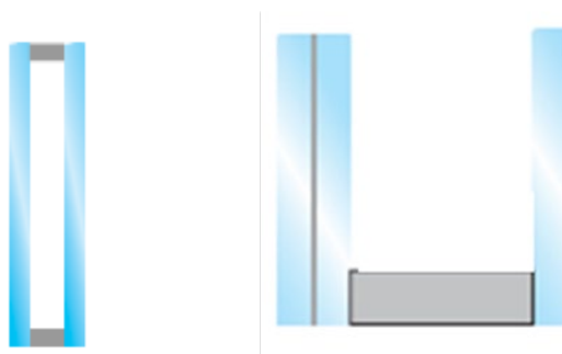
Figure 9 : schéma d'un vitrage isolant double de type 4/16/4 (à gauche) et 44.2/12/4 (à droite)
